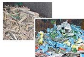
破碎処理後の木屑と プラスチック 同社HPより
